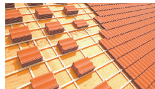
▲ De Nelskamp Climalife betonpannen in traditioneel rood. Ze zijn voorzien van een toplaag van 1 millimeter micromortel dat is voorzien van titaniumdioxide (TiO 2 ). Titaniumoxide heeft de eigenschap dat het fotokatalytisch wordt door UV-straling in het zonlicht. Stikstofoxiden die op de dakpannen neerslaan worden door het zonlicht omgezet in onschadelijk nitraat, dat met het regenwater wegspoelt.
